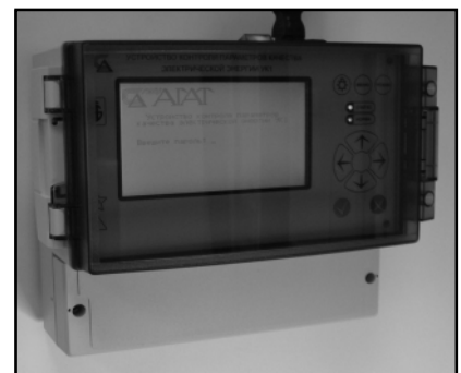
Рис. 1. Устройство контроля параметров качества электрической энергии УК1
