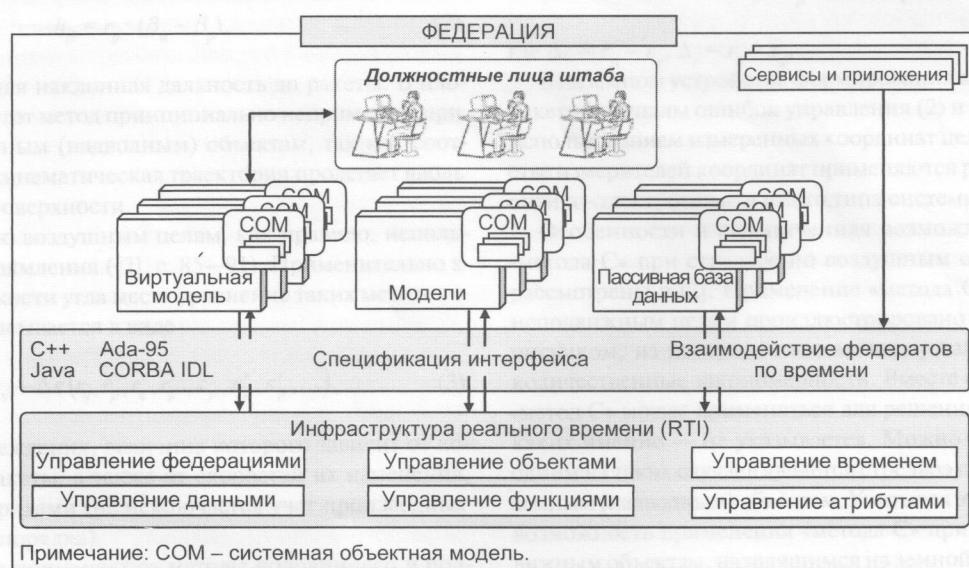
Рисунок 4 — Виртуальная интегрированная среда HLA поддержки процессов проектирования и реализации распределенных приложений
