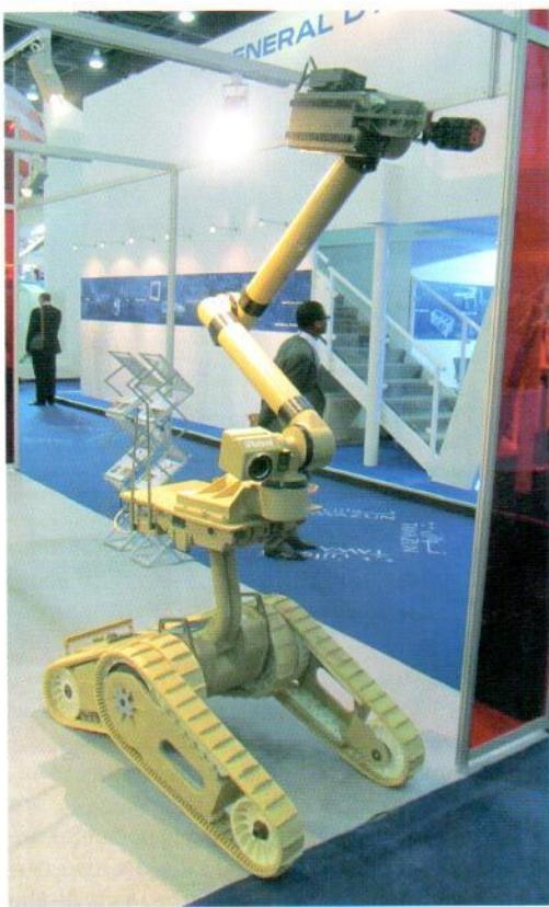
В составе полезной нагрузки имеется многостепенной механический манипулятор, который может использоваться как для выполнения точных работ по транспортировке и первичному осмотру подозрительных объектов, так и в качестве инструмента, повышающего проходимость МРК по пересеченной местности и при преодолении препятствий.
