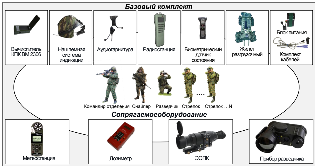
Рисунок 3 – Состав базового комплекта информационно-технического комплекса «Солдат – боевые системы» и сопрягаемого с ним оборудования
