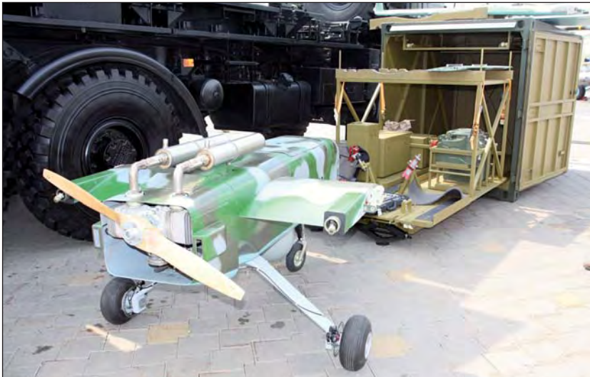
■ Lietajúci prostriedok 1LA-150 s demontovanými krídlom a chvostovými plochami
