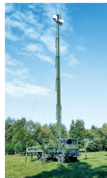
▲ Радиорелейная станция «Сосна-2» / Sosna-2 radio relay station
