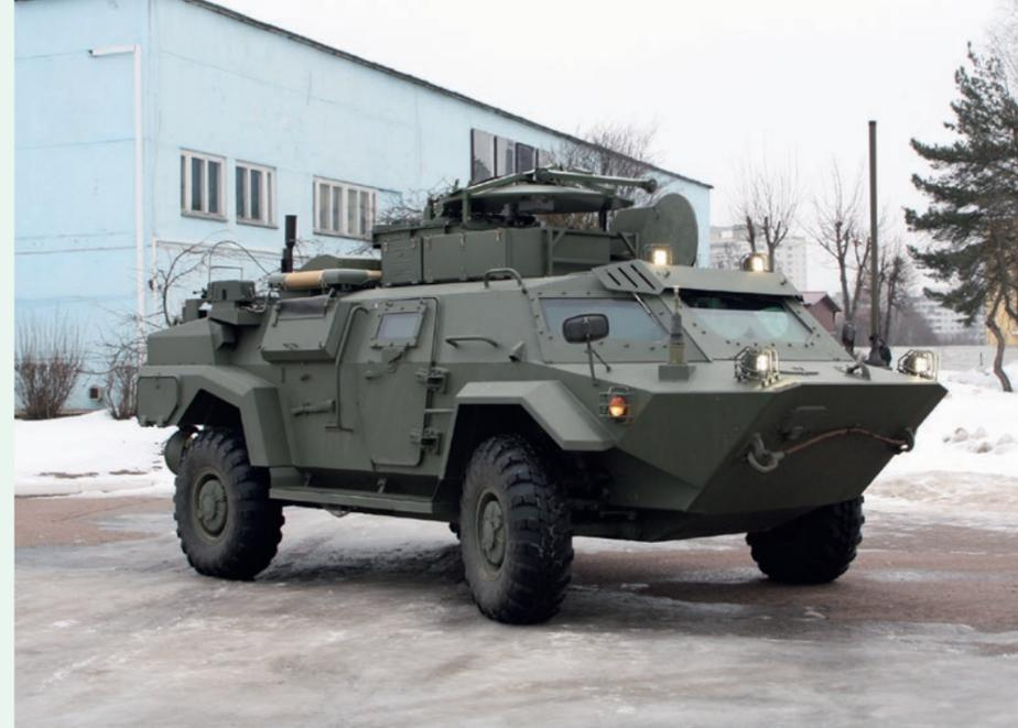
▲ КОМПЛЕКСНАЯ АППАРАТНАЯ СВЯЗИ ДЛЯ ПОДРАЗДЕЛЕНИЙ ТАКТИЧЕСКОГО УРОВНЯ УПРАВЛЕНИЯ НА БАЗЕ ОТЕЧЕСТВЕННОГО БРОНИРОВАННОГО ШАССИ «КАЙМАН» / INTEGRATED COMMUNICATIONS EQUIPMENT FOR TACTICAL UNITS MOUNTED ON A CAYMAN ARMoured
